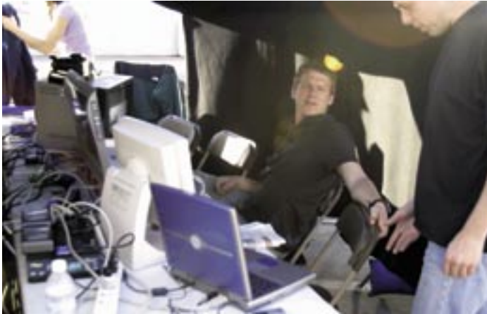
Arbeitsplatz am Set: Mit einem mobilen Schnittplatz wird unkomprimiert direkt auf Festplatte aufgezeichnet, an einer zusätzlichen Workstation lassen sich Kontroll-Compositings anlegen
