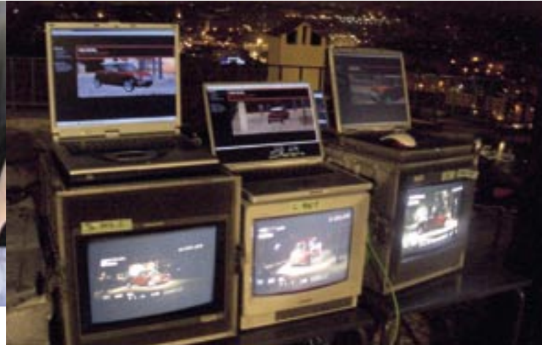
Kontrolle beim Nachtdreh: Vergleich der 3D-Prävisualisierung der Kameraeinstellungen von drei parallel aufzeichnenden HD-Kameras (oben auf den Notebooks) mit den aktuellen Videosignalen (Monitore unten)
